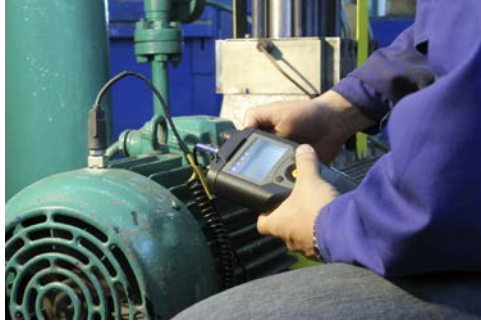
图2. 现有的设备振动偏移监控手动探头方法 缺乏可重复性和可靠性
