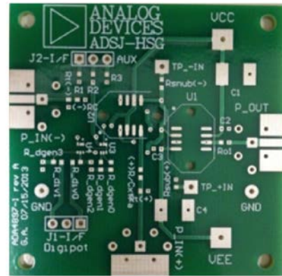
图 6. 放大器评估板，包含数字电位计连接
